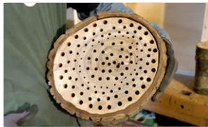
8. Achte darauf, dass die Bohrlöcher glatt gebohrt sind und keine Splitter rausstehen.
